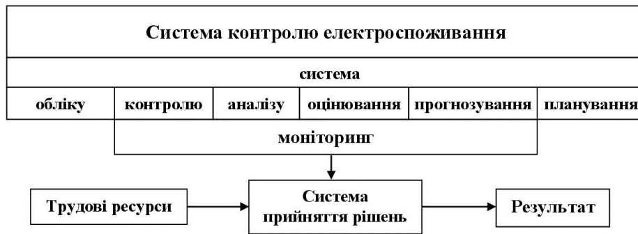
Рисунок 1 - Функціональна схема взаємодії усіх складових контролю електроспоживання
